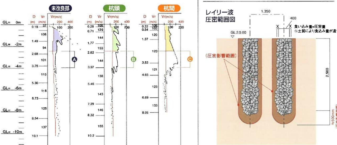
上記の速度断面図を比べてみると、未改良部との強度差は歴然である、さらにGL-2.5メートルの杭先端から鉛直方向に圧密の影響(強度上昇)がみられる。
